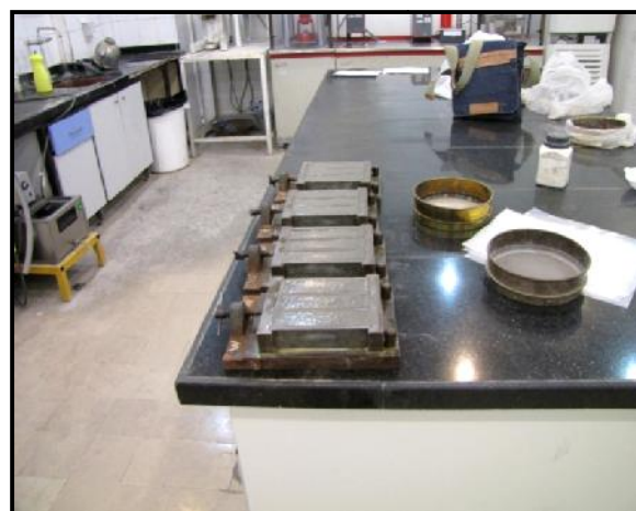
شکل ۱۶- قالب‌های تهیه بتن جهت آزمایش‌های
